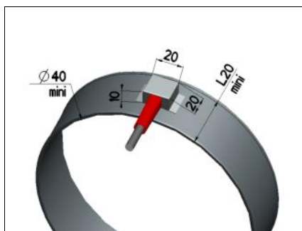
Réf. CSA - Câble serti orientation axiale Maxi 10A / 240V
