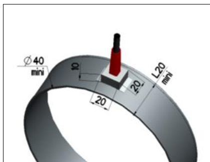
Réf. CSR - Câble serti orientation radiale - Maxi 10A / 240V
